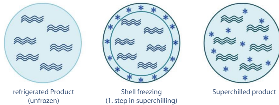
Abbildung 1.4: Die verschiedenen Schritte beim Superchilling von Lebensmitteln: Das im Produkt vorhandene Wasser ist teilweise gefroren und nach einer gewissen Zeit ist eine Mischung aus Wasser und Eis in der Struktur des Produkts vorhanden.
